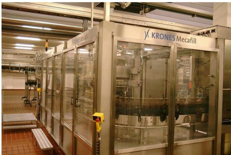
Flaschenfüll- und Verschlussmaschine
