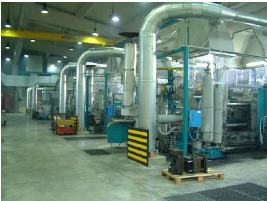
Absauganlagen bei Druckgussmaschinen
