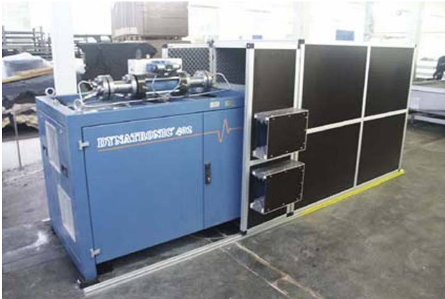
Hochdruckpumpe mit verschiebbarer Lärmschutzkapselung
