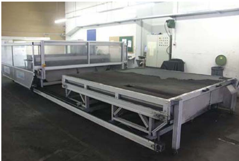
Wasserschneidanlage mit zwei Auflagetischen
