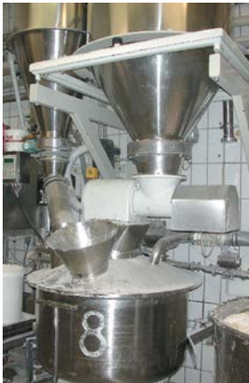
geschlossene Mehlausbringung mit Deckel und Absaugung
