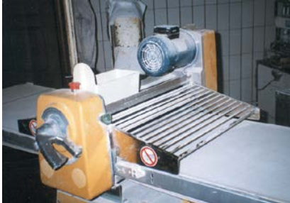
schlecht - die Motorabluft wird direkt über den Mehlbehälter geführt
