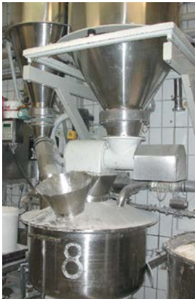
geschlossene Mehlausbringung mit Deckel und Absaugung
