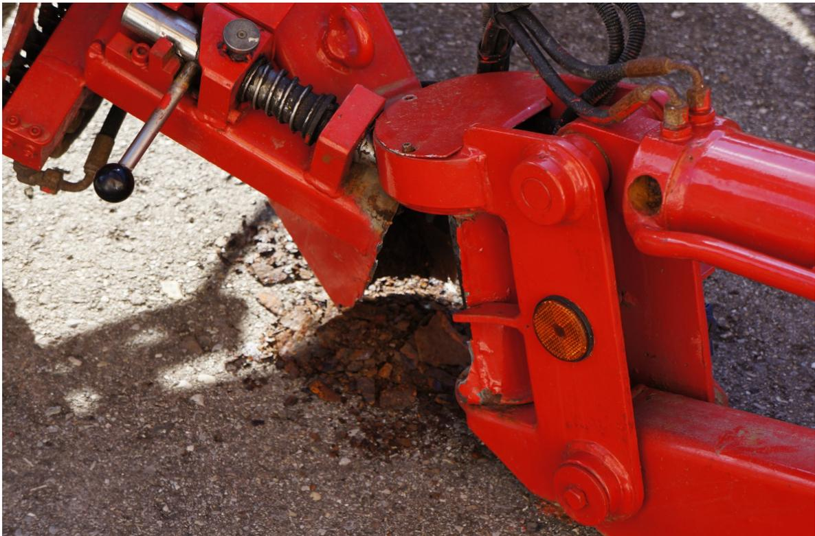
Bild: Schwenklager des Stützfußes
